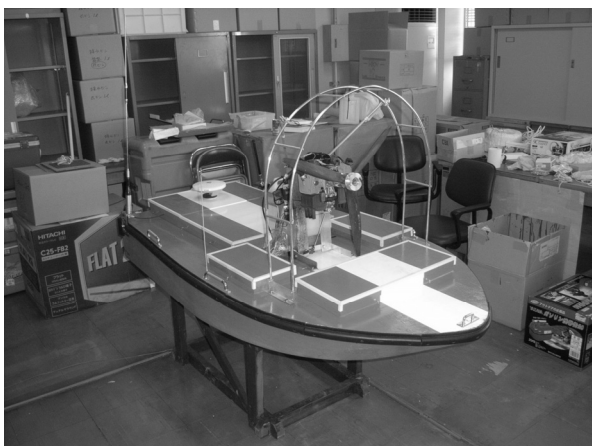
写真-2 流量・河床変動観測システム
