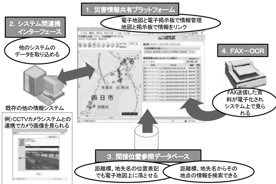
図-1 新災害緊急支援システムの概要
