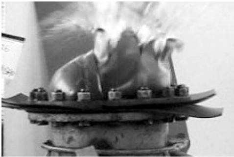
写真-1 水圧膨張試験によるシートの破断
