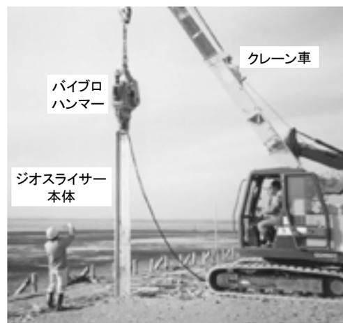
図-2 堆積物の柱状採取状況
