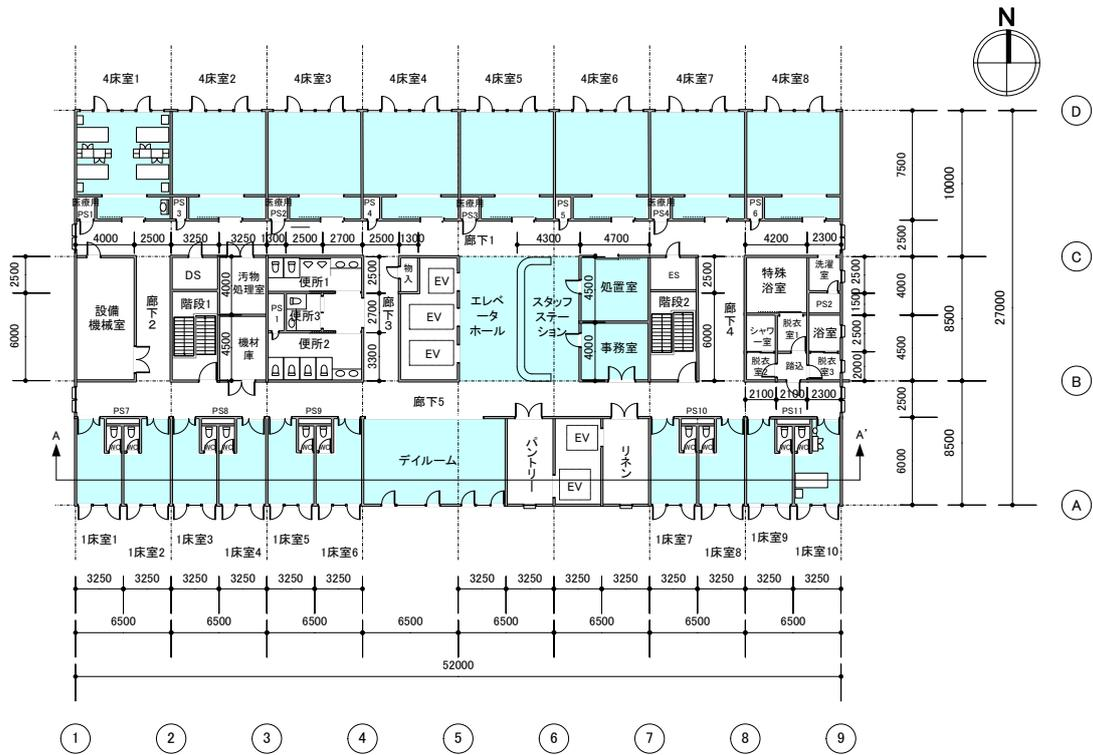
(b) 2～3階平面図 (基準階)
