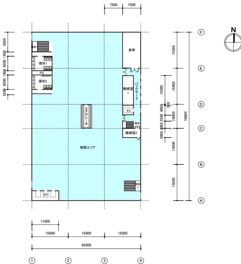
(b) 2~7階平面図 (基準階)
