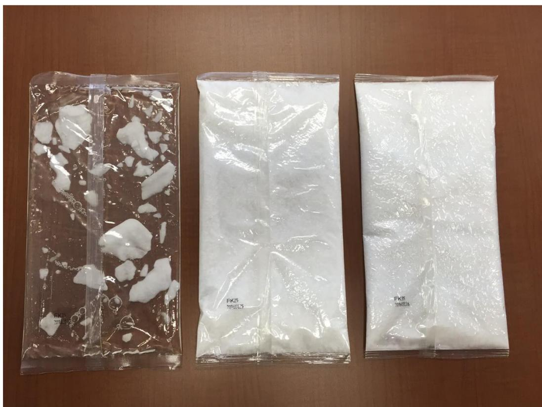
写真3-4 実験に用いた潜熱蓄熱材（左から15°C製品、25°C製品、35°C製品）
