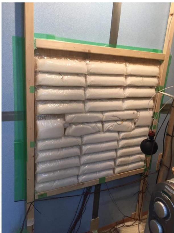
写真3-7 潜熱蓄熱材の設置状態
