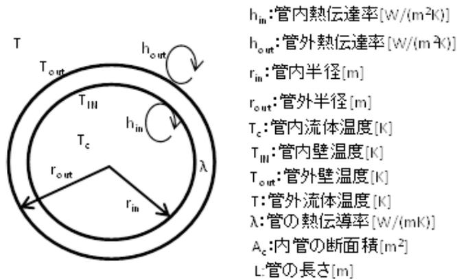
図4-35 地中埋設配管の計算モデル
