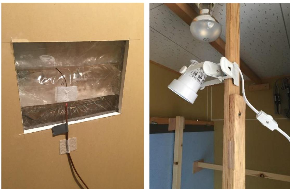
写真3-8 潜熱蓄熱材観察窓と撮影用のスポット光照射状況
