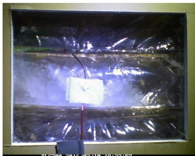
写真3-9 過冷却後の凝固（潜熱蓄熱材（15℃製品））
