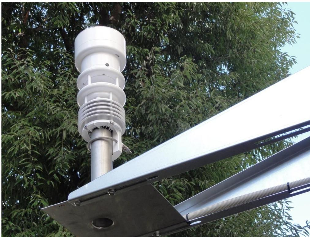
写真 5 - 6 複合気象センサーの設置状況
