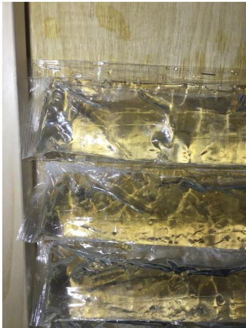
写真 3-6 液化した時の潜熱蓄熱材とパッケージの状態
