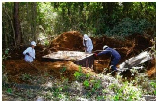
図-5.3.10 樹木根を含む土壌供試体の採取
