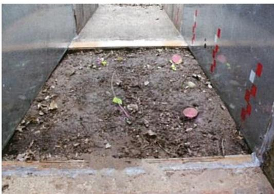
図-5.3.12 侵食実験前の供試体の土壌表面
