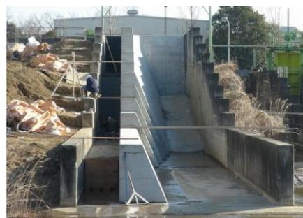
写真-4.2.1 構造物実験水路（縮尺 1/25）
