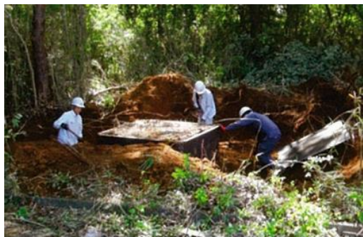
図-5.3.10 樹木根を含む土壌供試体の採取
