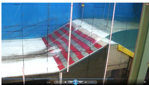
写真-4.2.3 残留水位による裏法尻からの吸い出し
