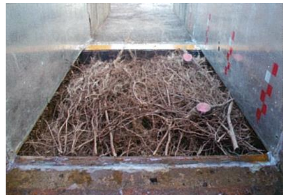
図-5.3.13 高流速を作用させた後の供試体の表面
