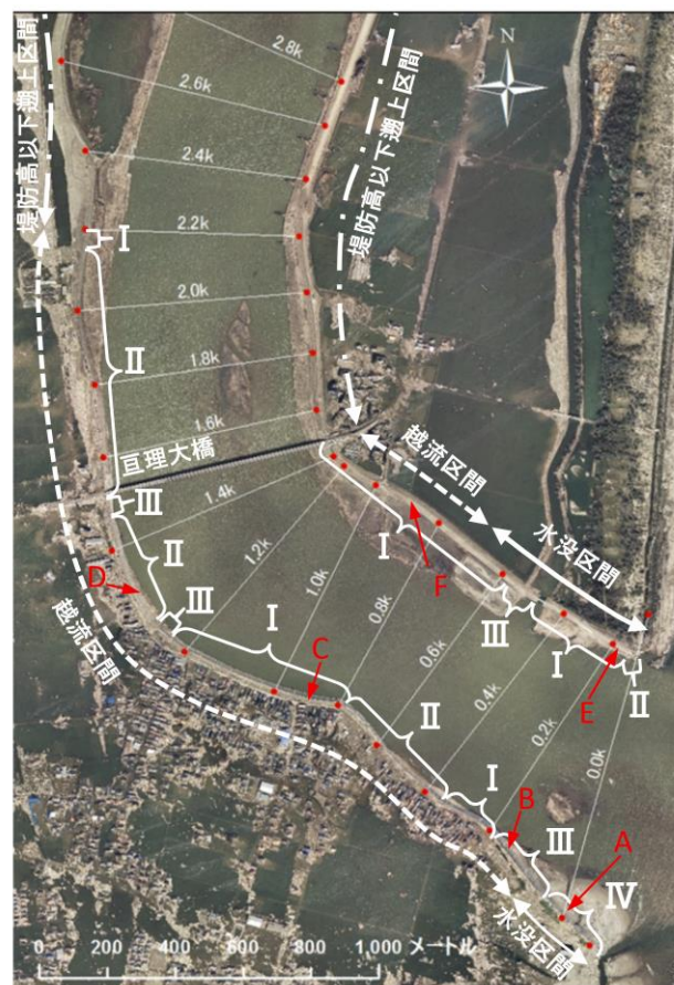
図-2.4.1 津波痕跡水位と堤防高の関係及び被災状況（写真は国土地理院撮影）
