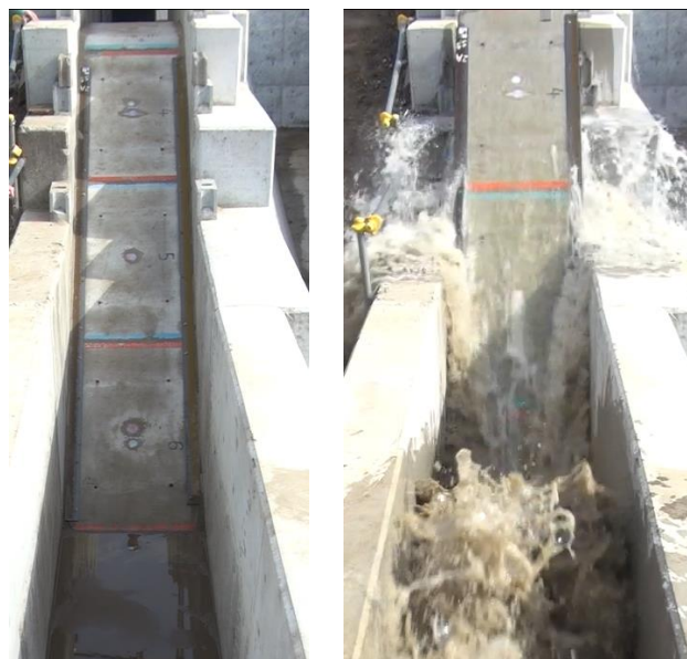
図-4.2.35 越流前後の状況（ケース 2、左から越流前，越流開始から 40 秒後）
