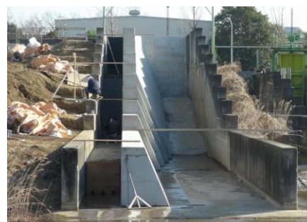
写真-4.2.2 高落差実験水路（縮尺 1/2）
