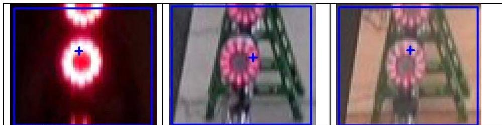
写真-7.6.18 中型赤色ターゲットの2値化処理による抽出結果 ※初期画像に比べ中心点がずれ
