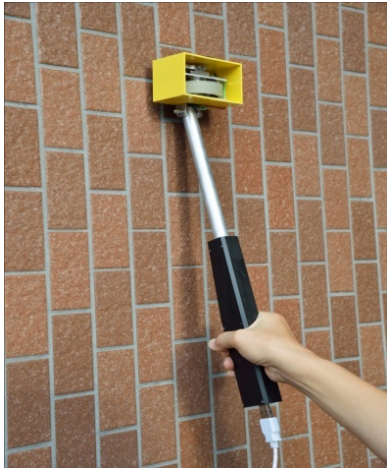
写真 3.6.9 手動型外壁診断装置
