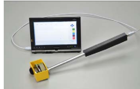
写真 3.6.10 手動型外壁診断装置と小型 PC
