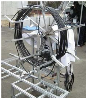
写真 3.6.6 落下防止装置（電源供給を兼ねたリールユニット）
