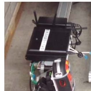
写真 3.6.8 位置計測のための移動装置（レーザ照射計と無線装置）
