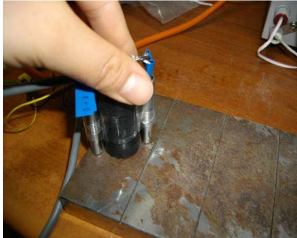
図-2. 2. 84 (b) 励磁プローブとデータ取得プローブ
