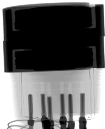
図-2.2.80(a) X線検査によるプローブ内部(大)
