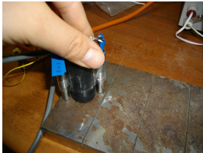
図-2.2.107 3 プローブでの探傷方法
