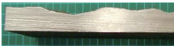
図-2.3.30 対象とする腐食供試体
