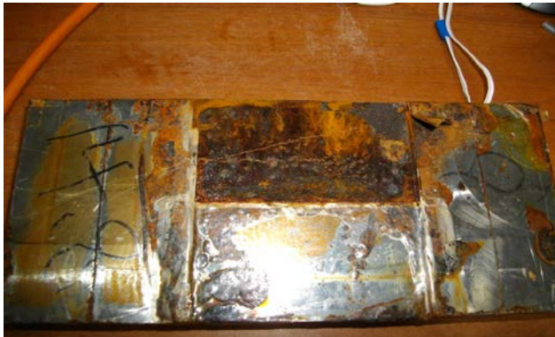
図-2. 2. 78 (a) 腐食試験体 (写真)
