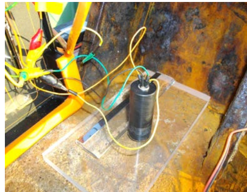
図-2. 2. 165 10 mmプラスチック板の上での探傷の様子
