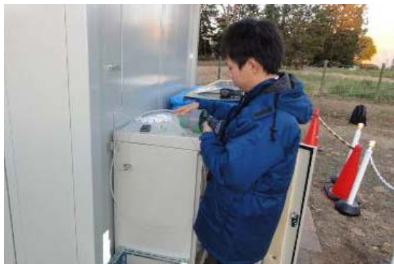
写真 2.10 外気放出口(テフロン管に付け替え)における水素濃度の計測
