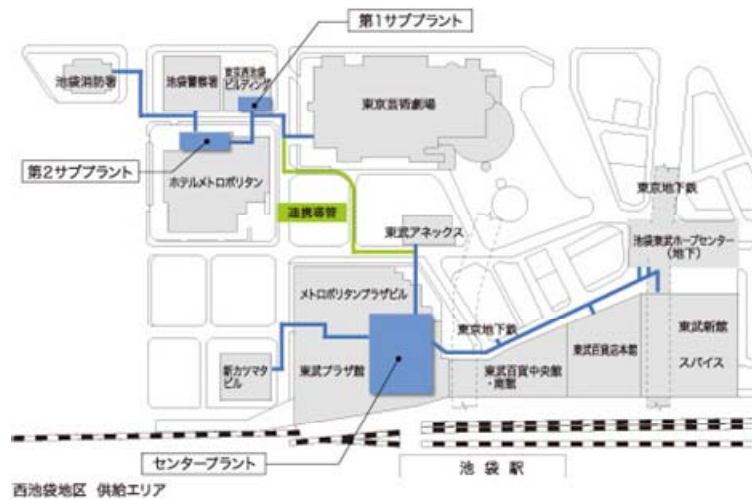
図 4.47 検討対象地域における地域熱供給システムの概要図
