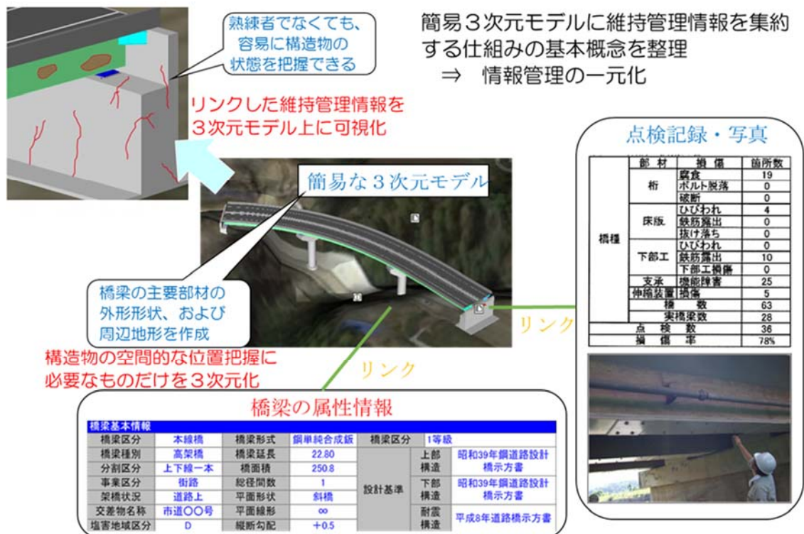
図 1-10 3次元モデルを用いた統合情報システムのプロトタイプ作成
