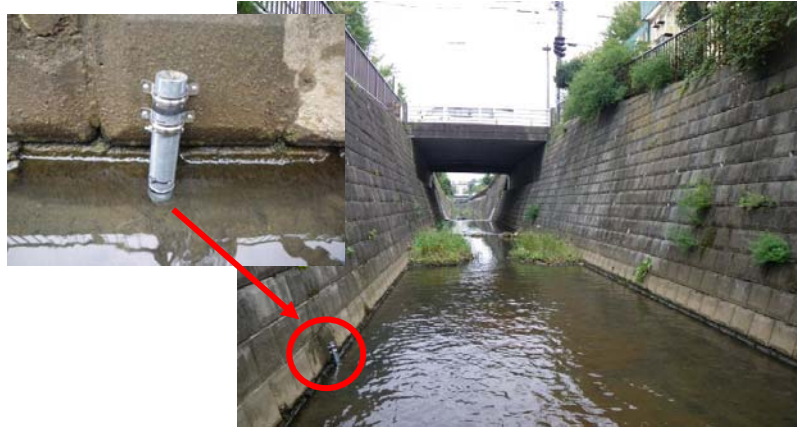
図-I. 1. 1. 2. 2 設置した水位計の状態
