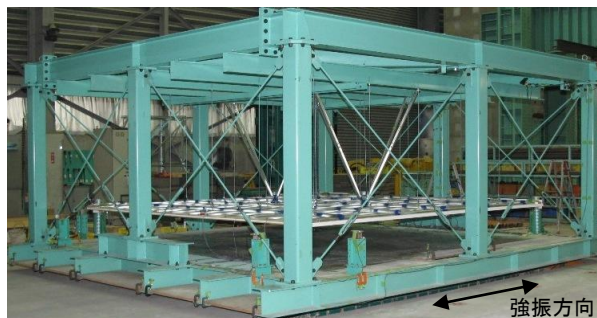
写真1 加力装置 試験体と鉄骨フレーム(架台)
