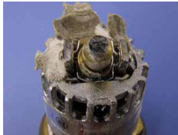
(2)ヘッド2：鋼管巻出し②(EI-centro1940 波 400%加振後)
