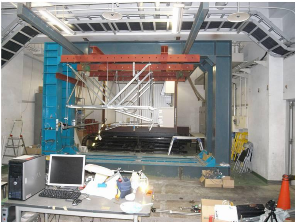
写真5 起振器を用いた動的实验装置
