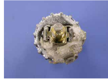
(1)ヘッド1：鋼管巻出し①(EI-centro1940 波 300%加振後)
