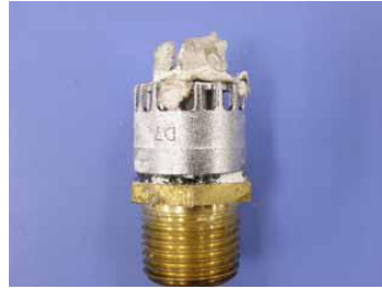
(1)ヘッド1：鋼管巻出し①(EI-centro1940 波 300%加振後)
