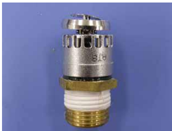
(3)ヘッド3：フレキ巻出し(EI-centro1940 波 400%加振後)
