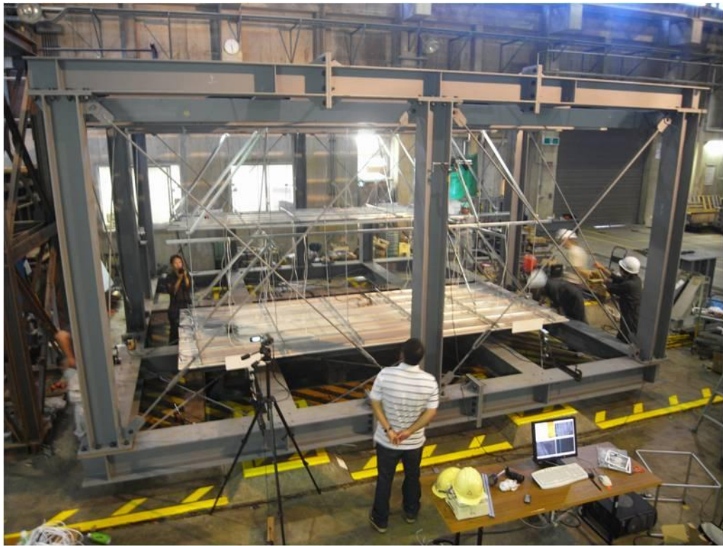
写真10 振動台を用いた動的実験装置（全体）
