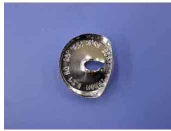
(2)ヘッド2：鋼管巻出し②(EI-centro1940 波 400%加振後)
