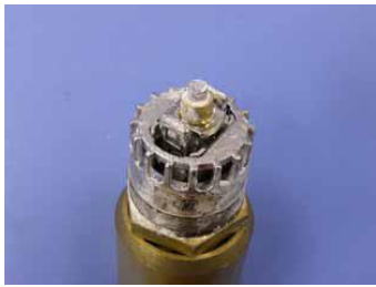
(1)ヘッド1：鋼管巻出し①(EI-centro1940 波 300%加振後)
