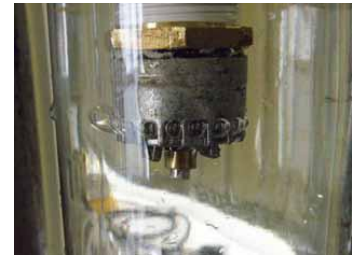
(1)ヘッド1：鋼管巻出し①(EI-centro1940 波 300%加振後)
