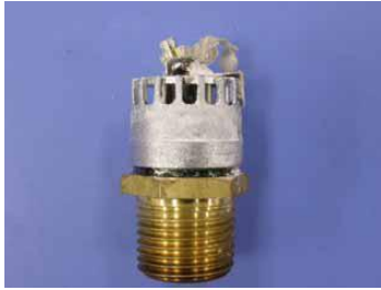
(1)ヘッド1：鋼管巻出し①(EI-centro1940 波 300%加振後)
