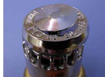
(3)ヘッド3：フレキ巻出し(EI-centro1940 波 400%加振後)
