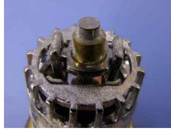
(1)ヘッド1：鋼管巻出し①(EI-centro1940 波 300%加振後)
