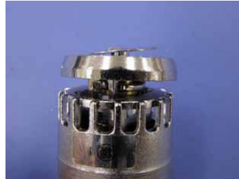
(3)ヘッド3：フレキ巻出し(EI-centro1940 波 400%加振後)
