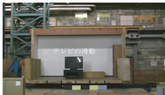
写真3 実験結果（南海2.5階（TMD有り）） [テレビ台のストッパーを効かせない場合]
