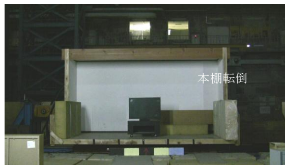
写真7 実験結果（南海4.8階（TMD無し）） [テレビ台のストッパーを効かせない場合]
