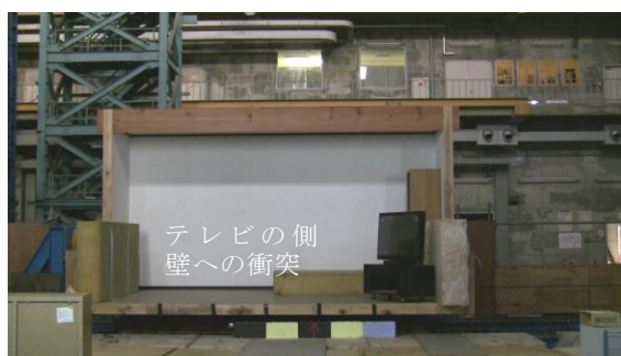
写真4 実験結果（南海4.8階（TMD有り）） [テレビ台のストッパーを効かせない場合]
