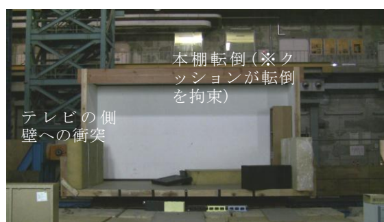
写真5 実験結果（南海4.8階（TMD無し）） [テレビ台のストッパーを効かせない場合]
