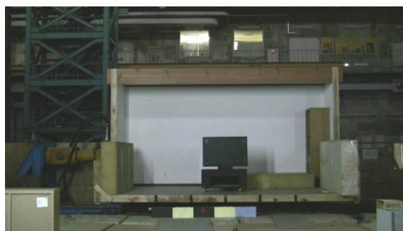
写真6 実験結果（南海4.8階（TMD有り）） [テレビ台のストッパーを効かせない場合]
