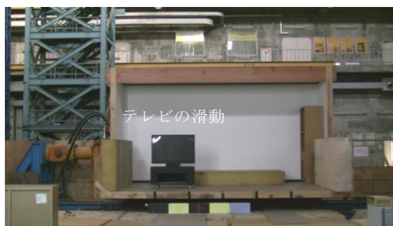
写真2 実験結果（告示波2.5階（TMD有り）） [テレビ台のストッパーを効かせない場合]
