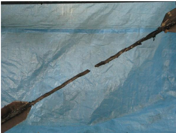
写真 5.3 ダンパー芯材局部座屈状況
