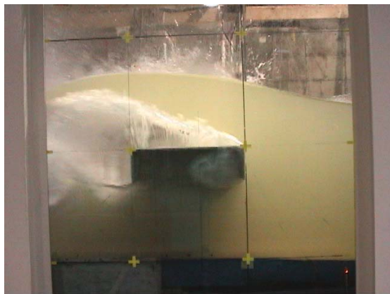
写真 2.5-2 水路実験において橋桁模型に衝突する孤立波
