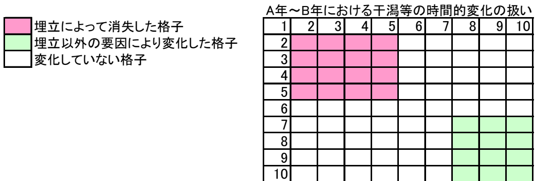
図 3.12 干潟、浅場、埋立の各面積の算定方法
