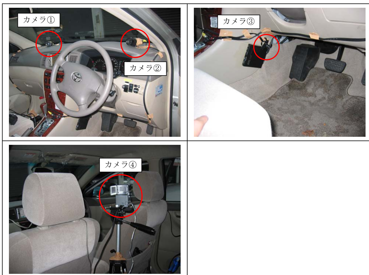
図-3.2.6 CCDカメラの設置状況
