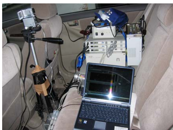
図-3.2.4 試験車両の計測機器の制御部
