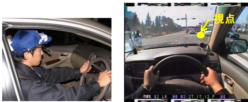
図-2.2.1 アイマークレコーダーの装着状況と注視点の抽出映像
