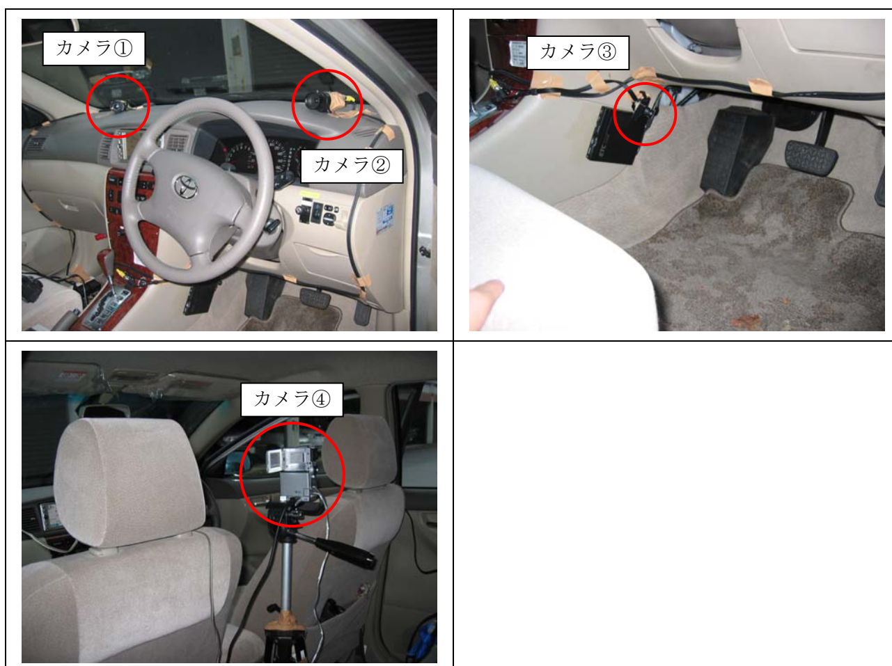
図-3.2.6 CCDカメラの設置状況
