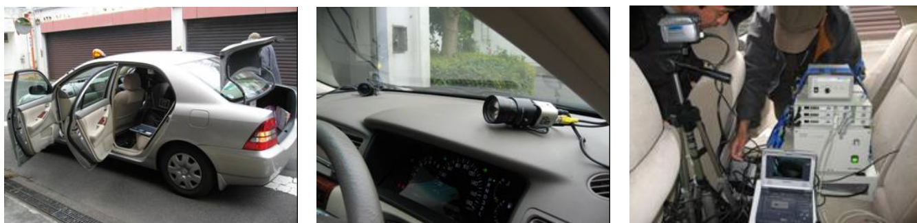
図-2.2.2 試験車両内の機器設置状況
