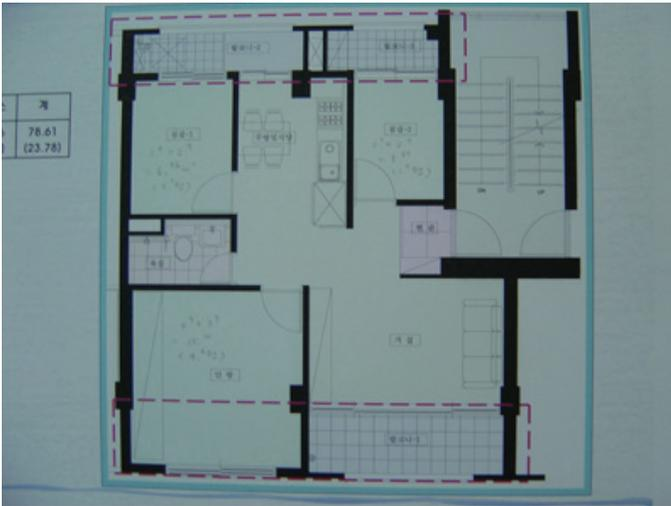
リモデリングでは、全住戸について、建物の正面及び背面方向への専有部分の面積の増築（写真の赤い点線囲み部分）、間取り変更が行われるケースが多い。
