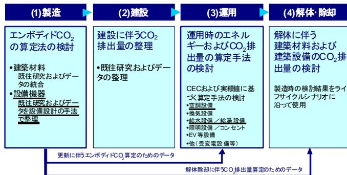
図 1.3.1 LCCO<sub>2</sub>およびLCEの検討概要
