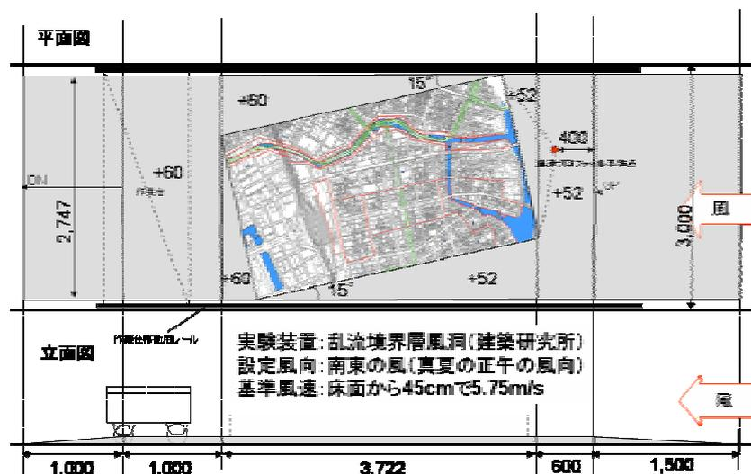
図 3-1-3 風洞内の模型の配置
