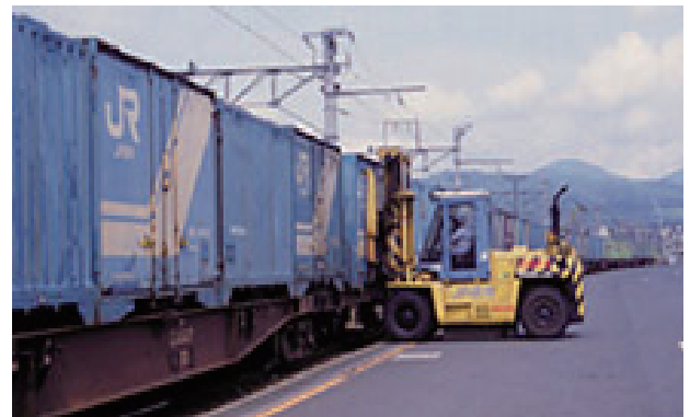
写真-3.1.2 着発線荷役方式の例
