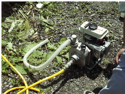
写真－４． １． ３ 自給式ポンプ
