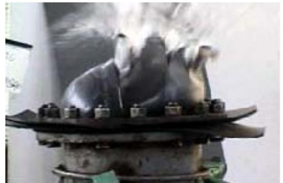
写真-3 水圧膨張試験によるシートの破断
