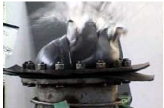
写真-3 水圧膨張試験によるシートの破断
