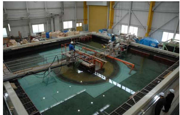
写真-4 大型水中振動台による動的載荷実験
