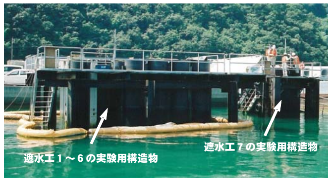
写真-5 各種の新形式遮水工の現地実証実験 外観(港湾空港技術研究所提供を改変)
