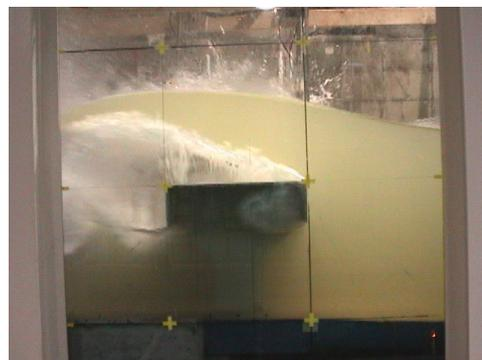
図 4.4-28 橋桁に衝突する孤立波( $H_0=40$ [cm],  $h=17.5$ [cm]).
