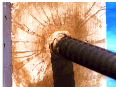
写真 3.1 「ひずみ硬化型高靱性セメント複合材料」の両引き試験供試体の例
