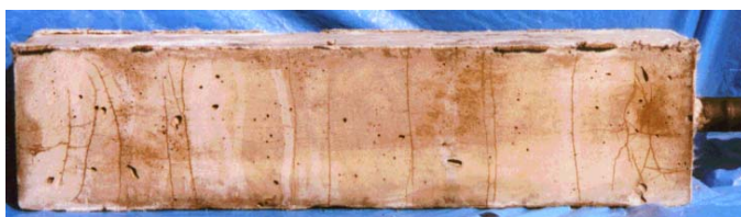
写真 3.1 「ひずみ硬化型高靱性セメント複合材料」の両引き試験供試体の例
