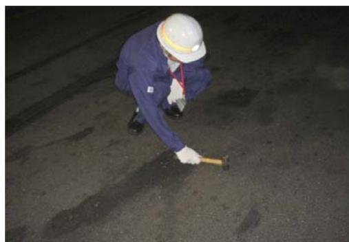
図 6.3.2 打音による剥離検査
