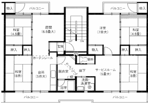
洗面所部分の戸境壁を半間程度抜いて左右住戸をつなげた2戸1戸化。片方の従前玄関は塞がれている
