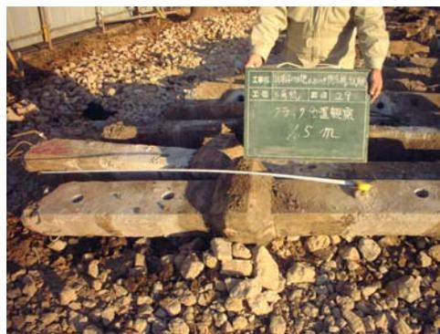
図2-3-8 三角節杭の目視検査
