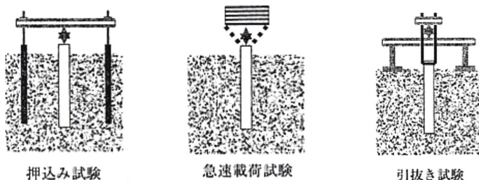
図2-3-4 鉛直支持力に関する試験方法
