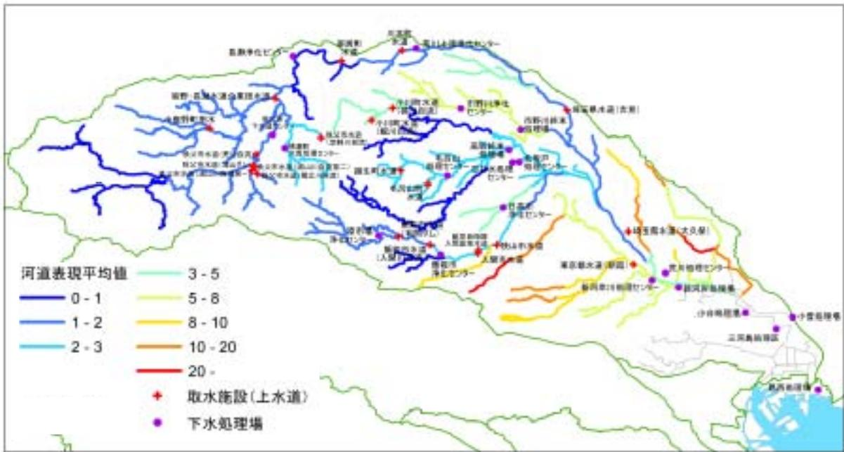
図-3.1.1.7 近年 10 年間 (H4 ~ H13) の BOD 平均値(mg/l) と上水道の取水位置
