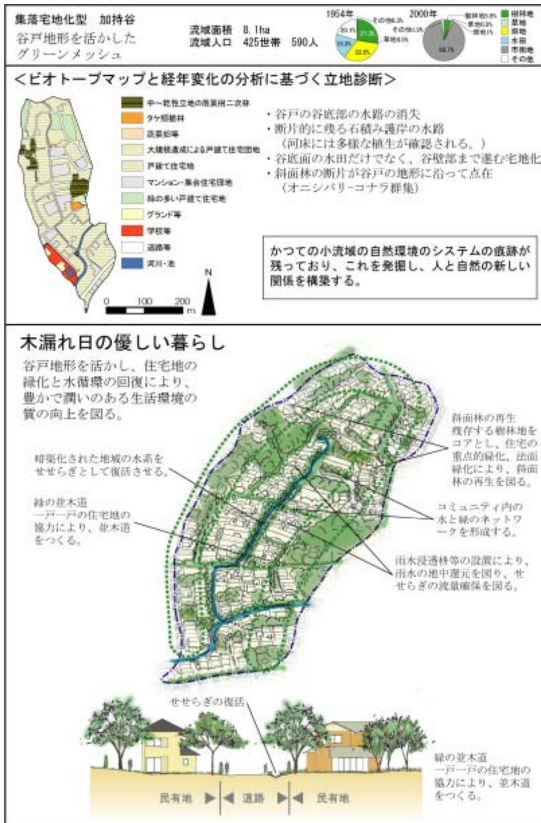
図- 4.3.2.4 小流域の立地診断と自然環境回復のための方針（集落・宅地化型:加持谷）
