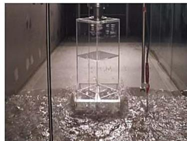
低抗力型建築物モデルの水理実験
