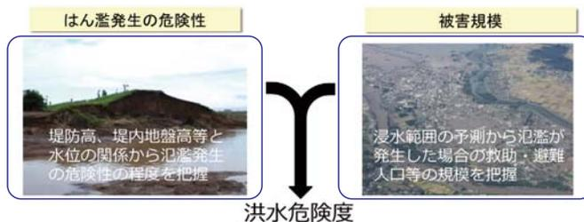
⇒氾濫発生危険性、氾濫が発生した場合の被害規模を合わせた洪水危険性の程度
