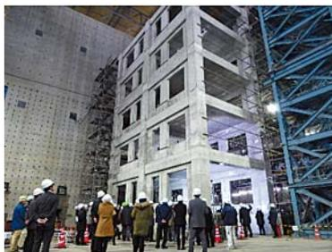
実大5層鉄筋コンクリート造建築物の載荷試験
