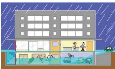
ゲリラ豪雨が流入すると、閉鎖された地下空間は急激な水位上昇により極めて危険な状況となる。
