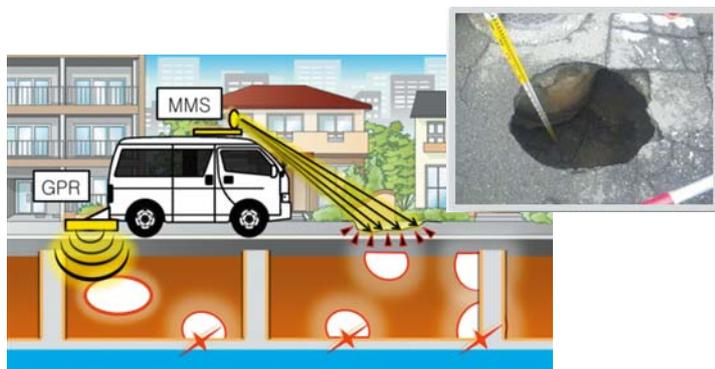
※GPR (ground penetrating radar): 地中レーダ探査装置
