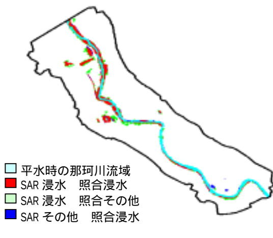
図 - 5 輝度値差分法による浸水域抽出結果
