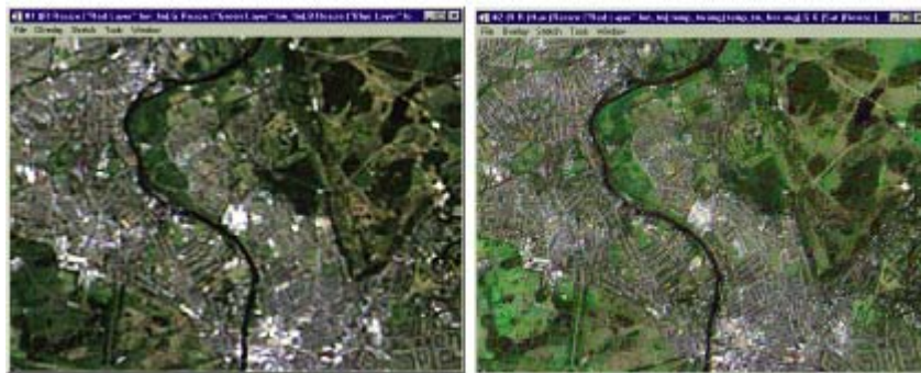
図 3-11 左が Landsat TM のデータ。SPOT のパンクロマティックデータをフュージョン(融合)させることにより、10m 解像度のカラー画像(右図)が作成される。
