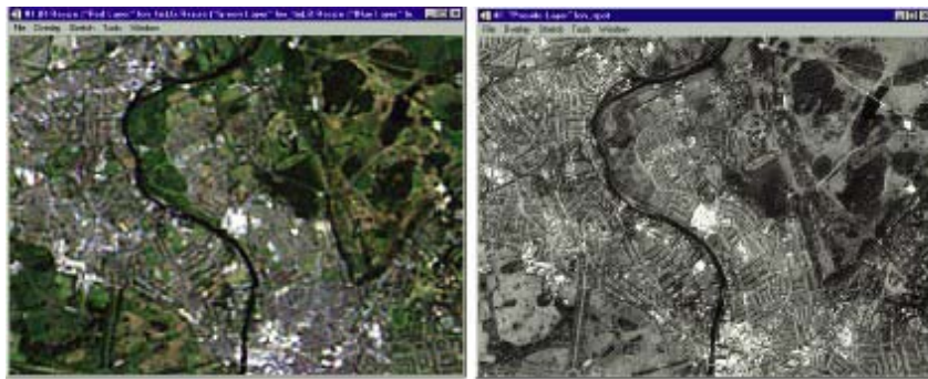
図 3-10 カラー合成の事例。イギリス、ロンドンを撮像したもので、右の図が SPOT の 10m 解像度のパンクロマティック(白黒)画像。左側が Landsat TM のトゥルーカラー合成図(28m 解像度)。
