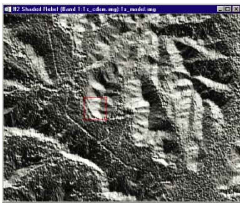
図 3-8 合成開口レーダ (SAR) 画像とデジタル標高モデル (Digital Elevation Model: DEM) を使用して作成した陰影強調画像
