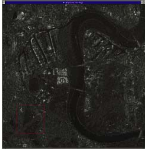
図6-21 SAR画像(RADARSAT)データからレーダのスペックルを除去したもの
