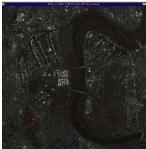
図6-20 Square-Rootストレッチを適用したドイツ、ボンのRADARSAT画像
