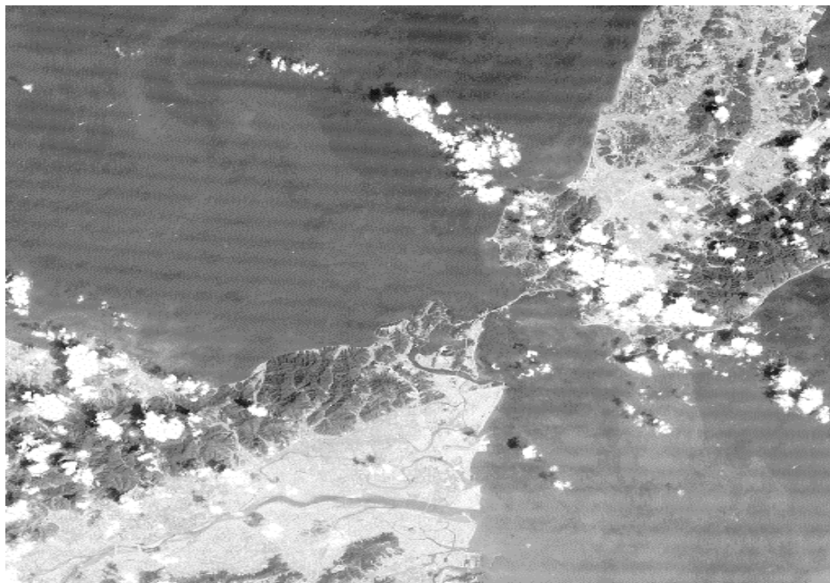
図 6-10 (a) ストライピングノイズが生じた画像
