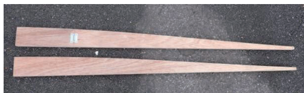
写真 サイン曲線形状の型枠 (CAD/PDFデータを使用して木工所で作成可能)
