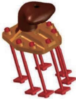
図-4 係船柱（曲柱）に関する全体構造（例）
