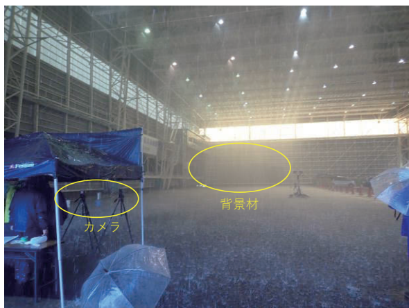
写真 降雨撮影実験の状況 (300mm/hr)
