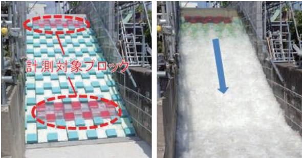
写真-2 流体力計測実験の様子
