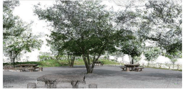
図-4 デジカメ写真から作成した点群データ
