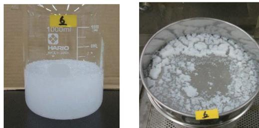
写真-1 離水処理前SAP 写真-2 離水処理後SAP
