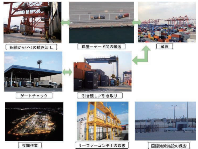
図-4 トランスファークレーン方式を採用するコンテナターミナルのアクティビティーとその流れ 5), 7), 8)
