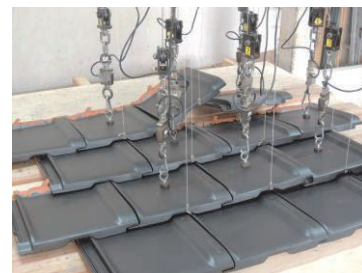
図-2 瓦屋根の載荷試験の実施例(F形瓦の場合)
