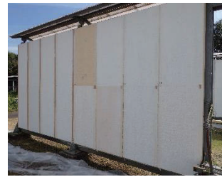
写真 仕上塗材の屋外暴露試験体の外観
