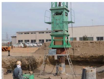
写真 鉛直載荷試験(急速載荷方式)の状況
