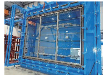
フロントサッシ試験体の耐風圧性試験
