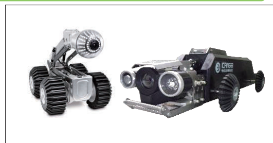
下水道管路を点検・調査する技術の例
