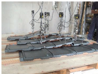
瓦試験体の引き上げ試験
