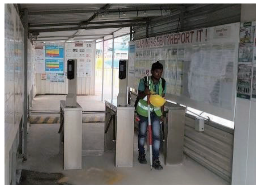
図 生体認証による工事現場への入退室管理
